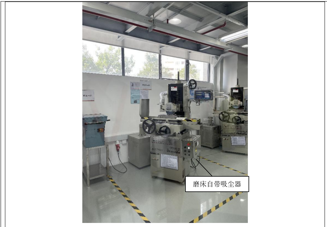
图 11 金属粉尘废气处理设施现场照片
